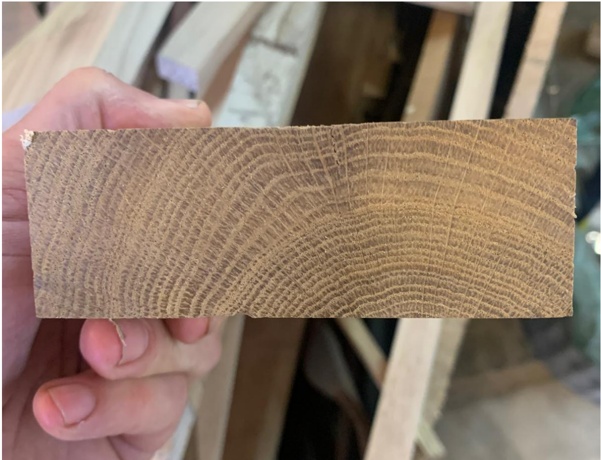
FIGURE 1 – Exemple d'image de bois de bout sur une section réelle de chêne, brute de sciage, telle qu'elle peut être observée en pratique avant préparation de surface. Les cernes annuels et les rayons médullaires y sont visibles à l'échelle macroscopique, dans un état de surface non idéalisé.
